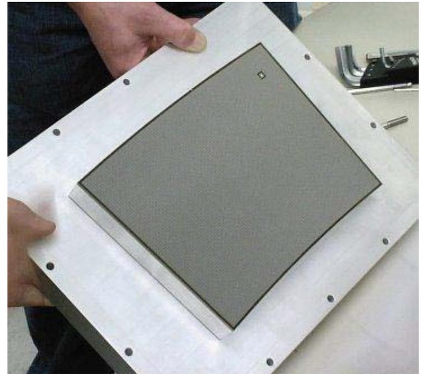
Carbon loaded kapton Micromegas module
