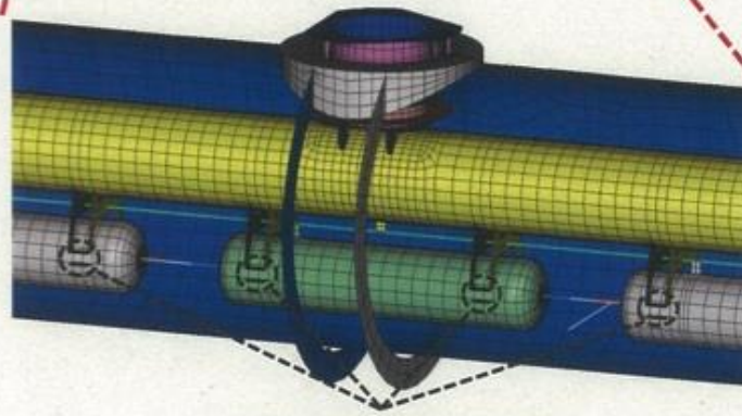
(b)拡大図【サポートポスト(中央部)】
