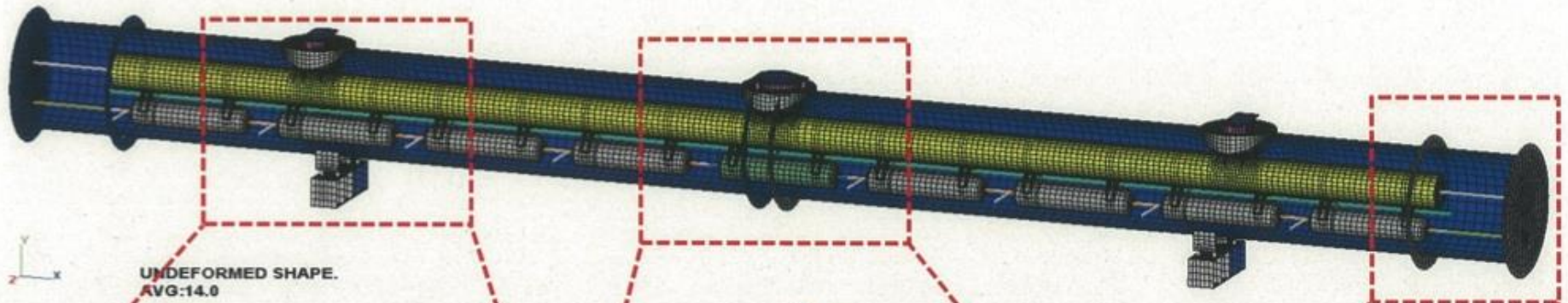
図5-10 剛性向上モデル メッシュ図(真空容器胴部1/2非表示, 鳥瞰図)
