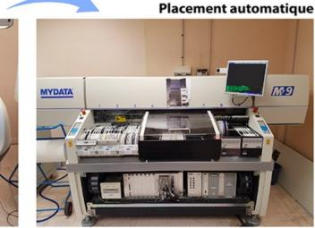
Machine de placement automatique MyData permettant la pose des composants CMS. Elle permet actuellement la pose de boîtiers de dimension jusqu'à 402.
