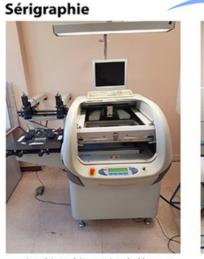
La sérigraphie consiste à déposer de la pâte à braser sur toutes les surfaces recevant des pattes de composants. Pour cela, il est nécessaire d'utiliser un masque de sérigraphie réalisé en sous-traitance.
