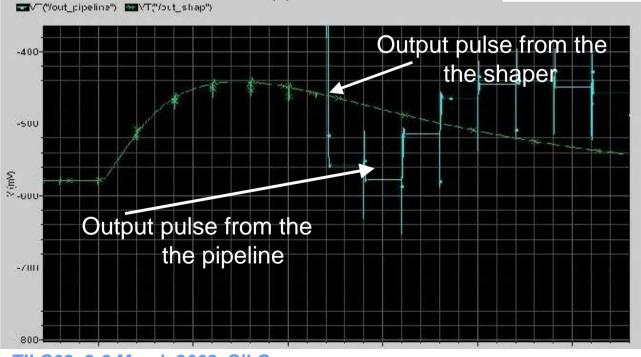
Pipeline avec output à 330ns de période d'échantillonage
