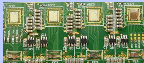
4 pairs of front-end+ADC ASICs
