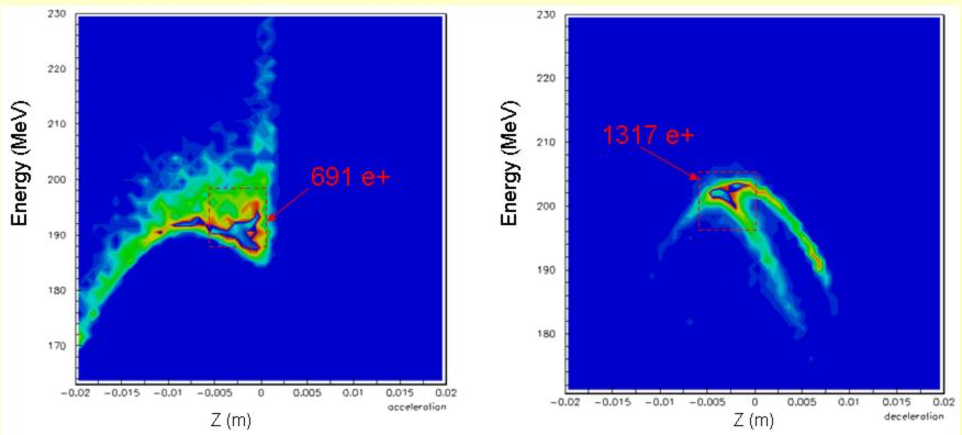
Positron yield: after target: ~8 e<sup>+</sup>/e<sup>-</sup> at 200 MeV: 0.9 e<sup>+</sup>/e<sup>-</sup> into PDR: 0.39 e<sup>+</sup>/e<sup>-</sup>
