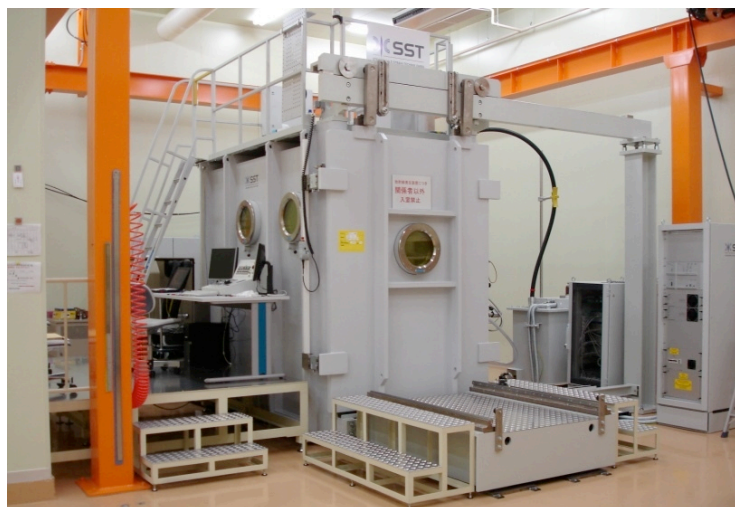
電子ビーム溶接機(ドイツSST社製) 最大ビーム電圧150 kV
