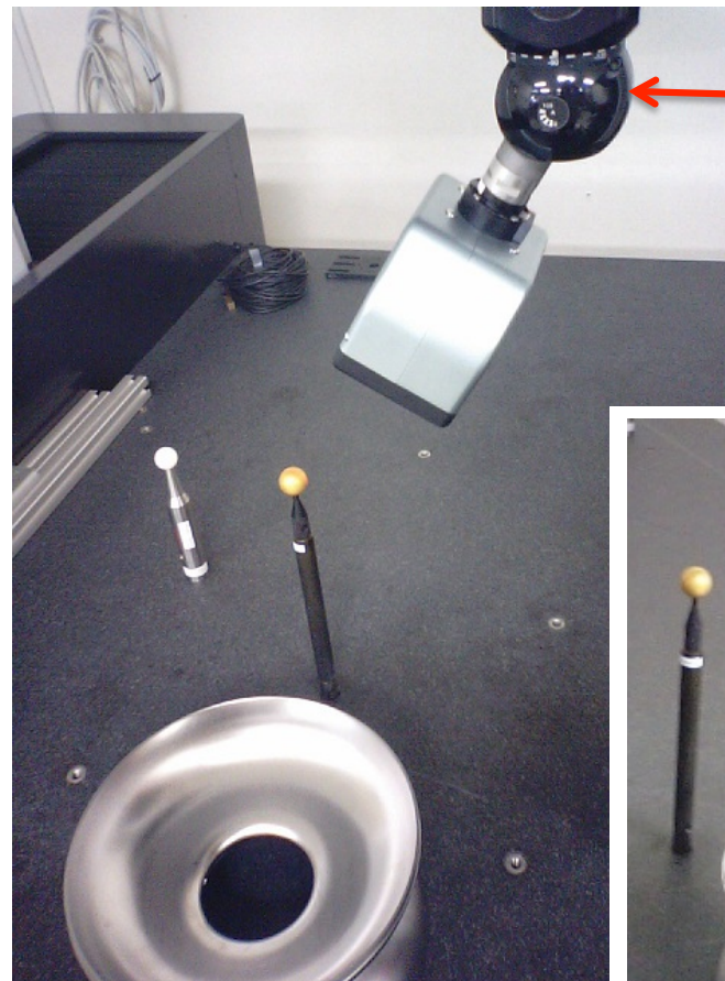
通常の3次元測定機の ヘッドに本測定機を取り付ける
