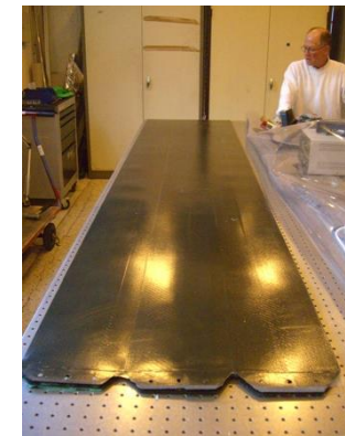
Long layer of 3 alveoli demolded (186,8 x 6,5 mm x 2,5m – 0,5 mm thick)
